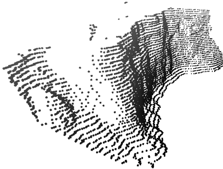
Figura 2 - Pontos que representam a topografia de uma frente de bancada
