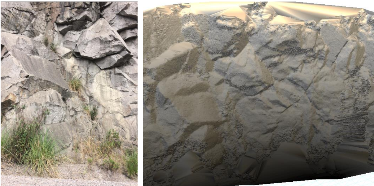
Figura 30 - Foto de uma frente livre e seu modelo tridimensional gerado através de técnicas de fotogrametria
